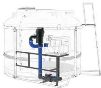
Комплект полного слива с фильтром и площадкой для мотопомпы на одну емкость TRF d75мм ПВХ
