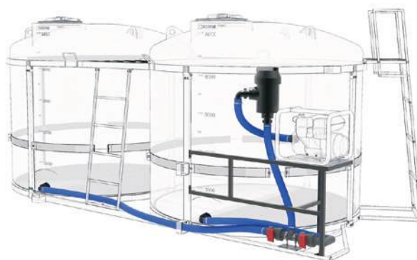
Комплект слива с фильтром и площадкой для мотопомпы на две емкости TRN d50мм ПВХ
