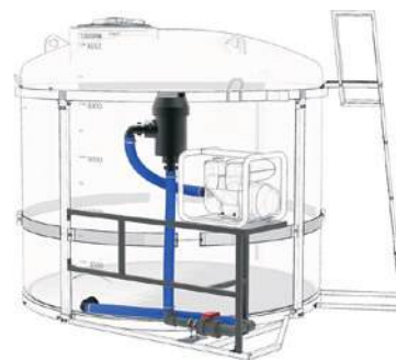
Комплект слива с фильтром и площадкой для мотопомпы на одну емкость TRN d50мм ПВХ
